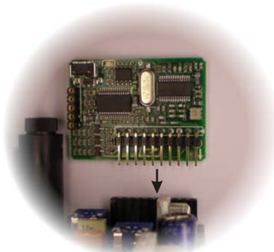
2. ábra: A vevőpanel csatlakoztatása a vezérlő egységhez
